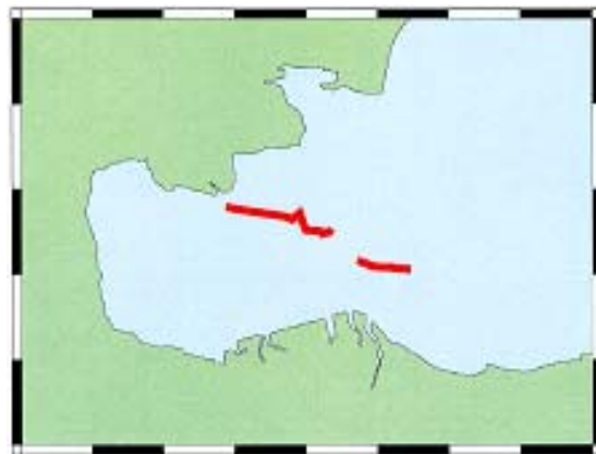
図8 2つの断層モデル. (a)Model1:別府湾海底活断層系が一括して活動したモデル. (b)Model 2:別府湾中央断層が独立して活動したモデル
