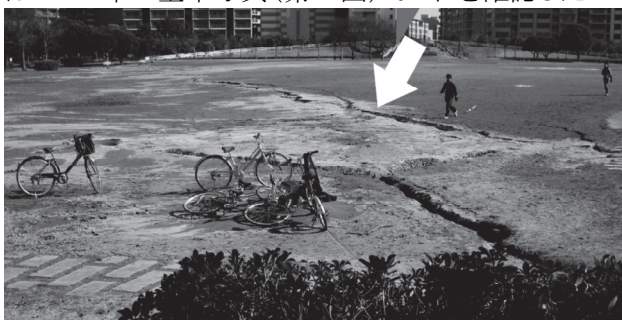
第1図 幕張海浜公園における地割れ: 矢印. 樋口ほか(2011)を修正. NW-SE方向で、延長約120m, NNE落ち(写真では手前)、落差約20cm、開口性. 地割れの片側(北側)のみに噴砂が分布する(2011.3.17撮影).
