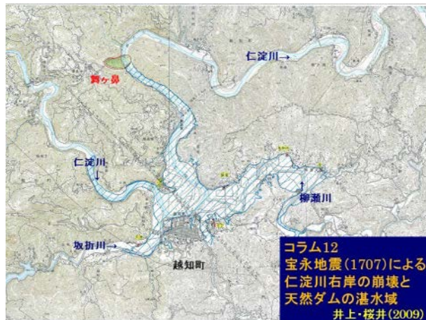
図1 仁淀川中流右岸の崩壊と天然ダムの湛水範囲「南無大師扁照金剛 宝永七(尾名川村惣中)」と記されている。地元では「石碑より下に家を建てるな」という言い伝えが残っており、標高61mより下には人家がなく、水田となっている。
